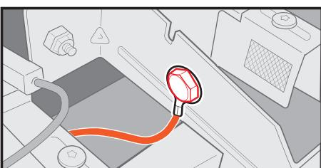
⚠ ТОЛЬКО 435 МОДЕЛИ: Кольцевой разъем должен быть надежно прикреплен к коллектору с помощью винта.
