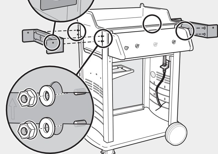
Dokręcić nakrętki aż do wpuszczenia. Dodatkowo dokręcić tylko o ćwierć obrotu. NIE UŻYWAĆ NADMIERNEJ SIŁY PRZY DOKRĘCANIU.
